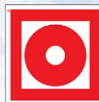
F10 Кнопка включения установок (систем) пожарной автоматики
