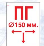
F30* Пожарный гидрант
