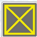
3.34д Въезд на перекресток в случае загорания запрещен
