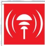
F12-01 Пункт извещения о пожаре
