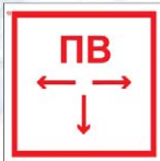
F40 Пожарный водосточник
