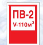
F31* Пожарный водосточник
