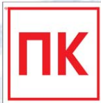
F41 Пожарный кран
