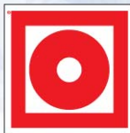
F10 Кнопка включения установок (систем) пожарной автоматики
