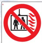
P44 Пользование лифтом во время пожара запрещено
