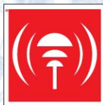
F12-01 Пункт извещения о пожаре
